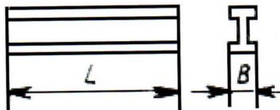
Рисунок 5 – Общий вид, обозначение основных размеров линеек ШД
