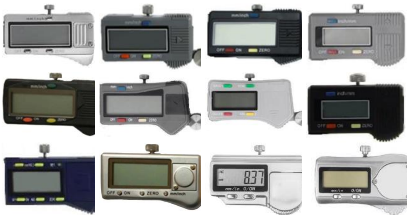
Р и с у н о к 15 – Общий вид цифрового отсчетного устройства штангенциркулей
