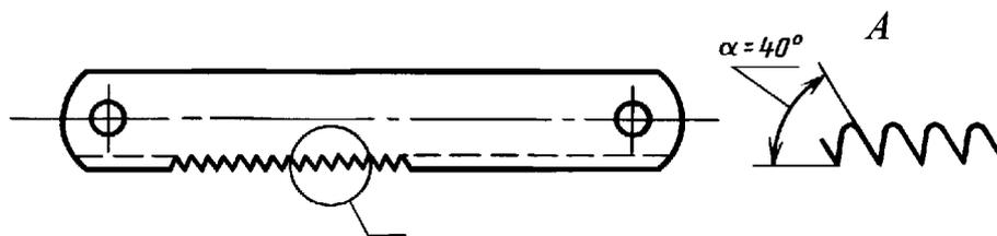
Передний угол  $\gamma = 0^\circ$ .
