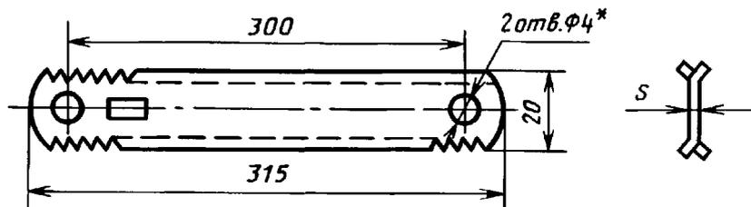
\* Допускается изготавливать полотна с посадочными отверстиями диаметром 6 мм и шириной 25 мм.
