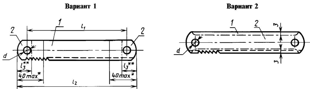
\* Допускается 60 мм для полотен с разводкой по всей длине полотна.
